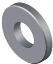
Die Dichtscheiben sind in 0,5 mm-Schritten erhältlich, d.h. sie überbrücken 0,4 mm, und zwar vom Nennmaß zum kleineren Durchmesser hin. Für einen Bohrer mit D 5,7 wird also eine Dichtscheibe mit Nennmaß 6 mm verwendet.
